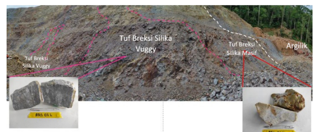
Gambar 7. Singkapan tuf breksi teralterasi silika vuggy dan silika masif pada tuf breksi lainnya (Grab sampling, ARS022 dan ARS026)
