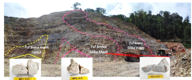
Gambar 6 Singkapan tuf breksi teralterasi argilik lanjut dan tuf breksi teralterasi silika massif (Grab sampling, ARS027, ARS018, dan ARS020)
