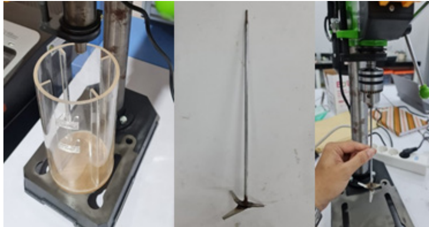
Gambar 3. Perancangan wadah, Propeller dan Mesin Agitator
