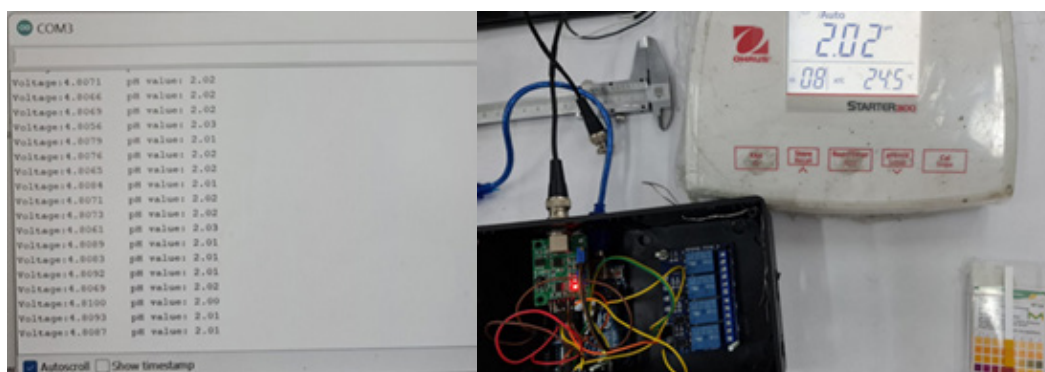
Gambar 5. Hasil pembacaan alat sensor (kiri) dan alat OHAUS Starter 3100 (kanan)
