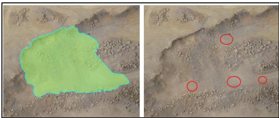
Gambar 8. Analisis jarak flying rock dengan ArcGIS
