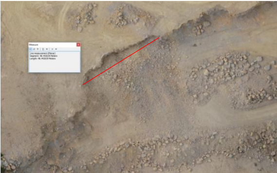
Gambar 7. Pengukuran lebar dinding setelah peledakan
